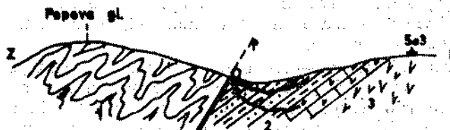
Prof. 1. Tektonski i hidrogeološki odnosi u zoni isticanja Milinice. — 1. Škriljci; 2. Laporci i pešćari; 3. Opalasti krečnjaci i opalske mase; R. Moravsko-zaplanjska dislokacija; O. izvor
